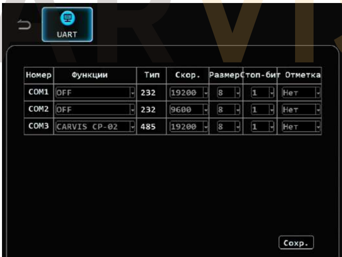
Рисунок 101 – Настройки во вкладке «UART» при подключении CARVIS CP-02 (RS-485) на примере CARVIS MDA-498HDD lite
