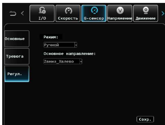
Рисунок 74 – Калибровка направления G-сенсора в ручном режиме
