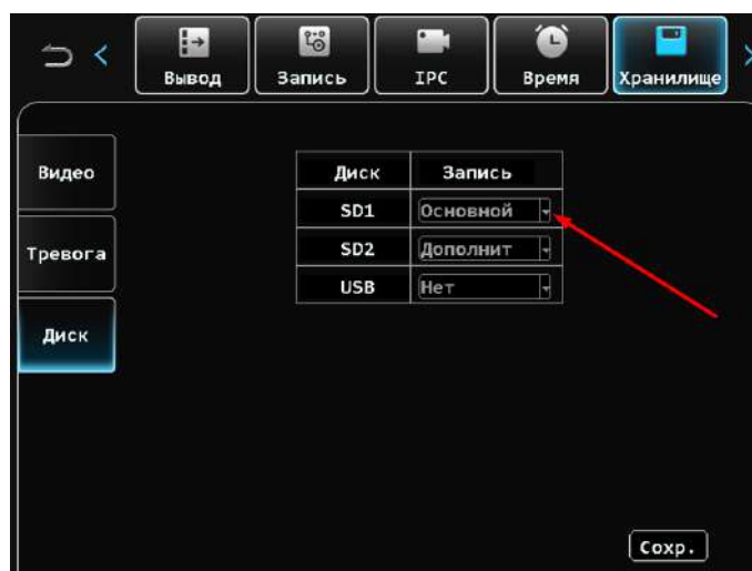
Рисунок 30 – Вкладка «Диск», настройка записи основного потока на примере CARVIS MDA-494SD
