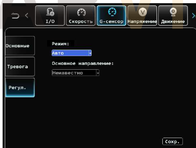
Рисунок 77 – Калибровка направления G-сенсора в автоматическом режиме
