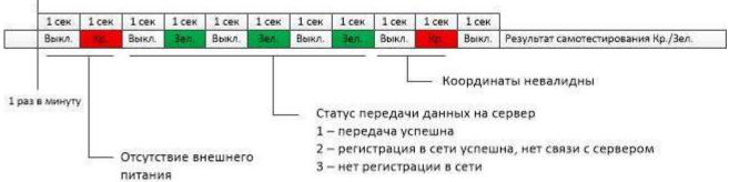
Стандартное состояние светодиода зависит от результата самотестирования устройства (горит красным, если выявлена неисправность, не горит – если неисправность не выявлена). Раз в минуту индикатор последовательно отображает статус внешнего питания, передачи данных на сервер и валидности (захвата) координат местоположения.
