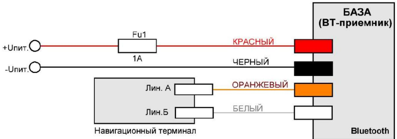
Схема подключения дискретных входов
