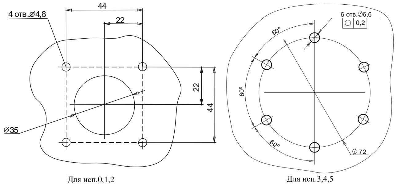
\* Даны диаметры отверстий под саморезы, при необходимости разметить по центрам указанных отверстий места под другой крепеж
