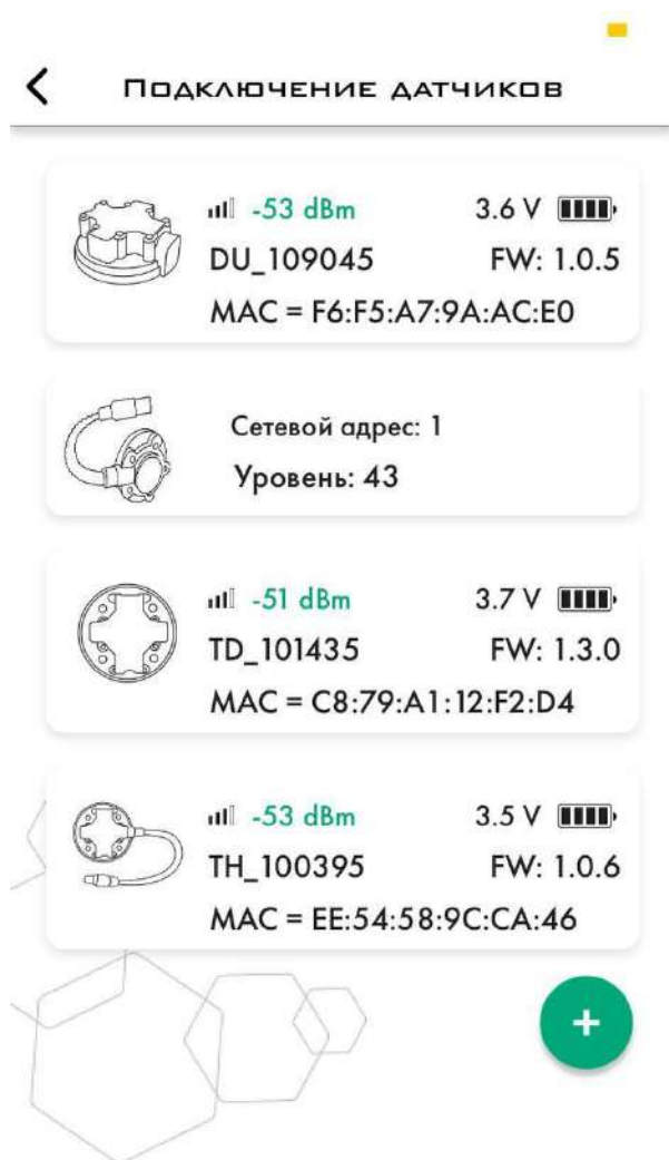
Рис. 19 Основной экран индикатора с несколькими (до 10) подключенными датчиками
