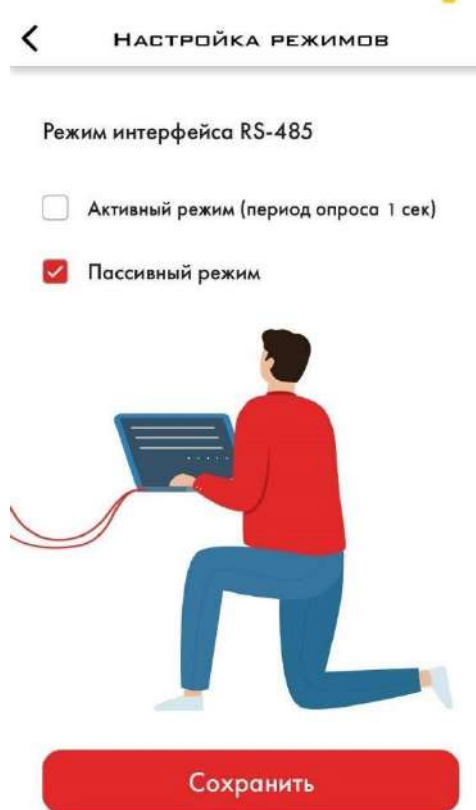
Рис. 28 режим RS-485: стандартные настройки
