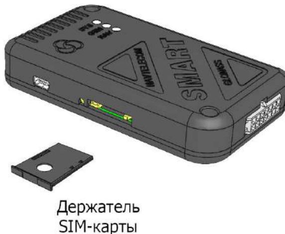
Рис. 17. Установка SIM-карты в устройство
