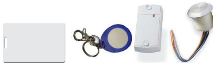
Рис. 36. Внешний вид Proximity-карт и брелоков и возможные варианты их считывателей
