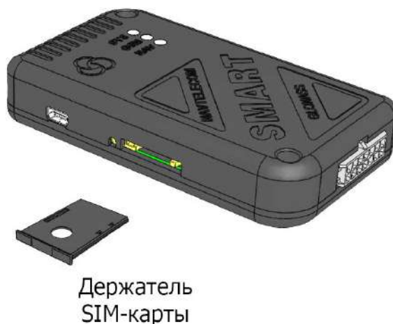
Рис. 15. Установка SIM-карты в устройство
