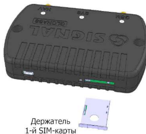
Рис. 22. Установка SIM-карты 1 в устройство
