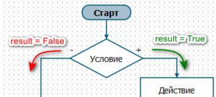
Рисунок 4.6 – Направление исполнения программы в зависимости от значения переменной result
